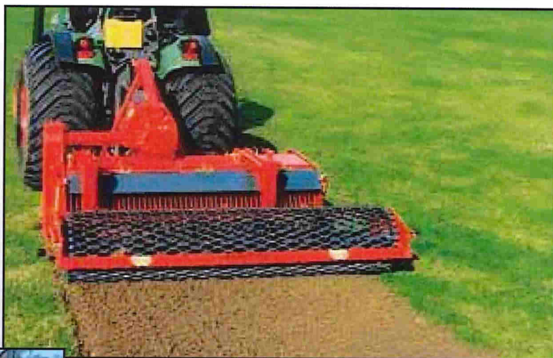
Travail direct à l'aide d'un enfouisseur RD 150
