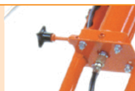
Contrôle d'inclinaison des pale avec pompe hydraulique
