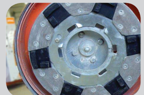
Montage des 6 outils de ponçage sur SM280
